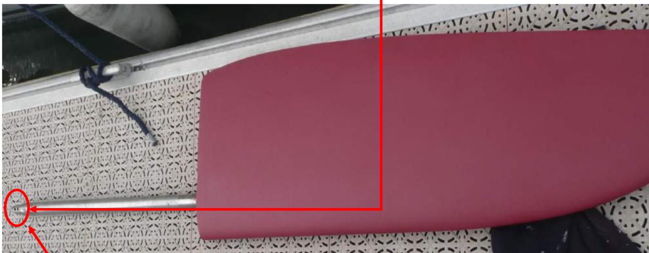
5/ Positionner la bague inférieure sur le safran
